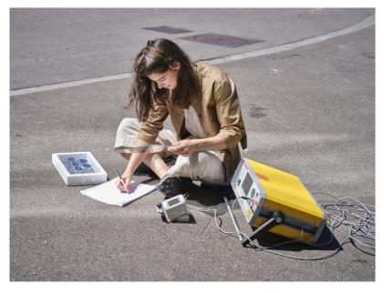
Die Master-Studentin mit einem Prototyp einer selbst entwickelten Fassade mit integrierter Photovoltaiktechnologie.
