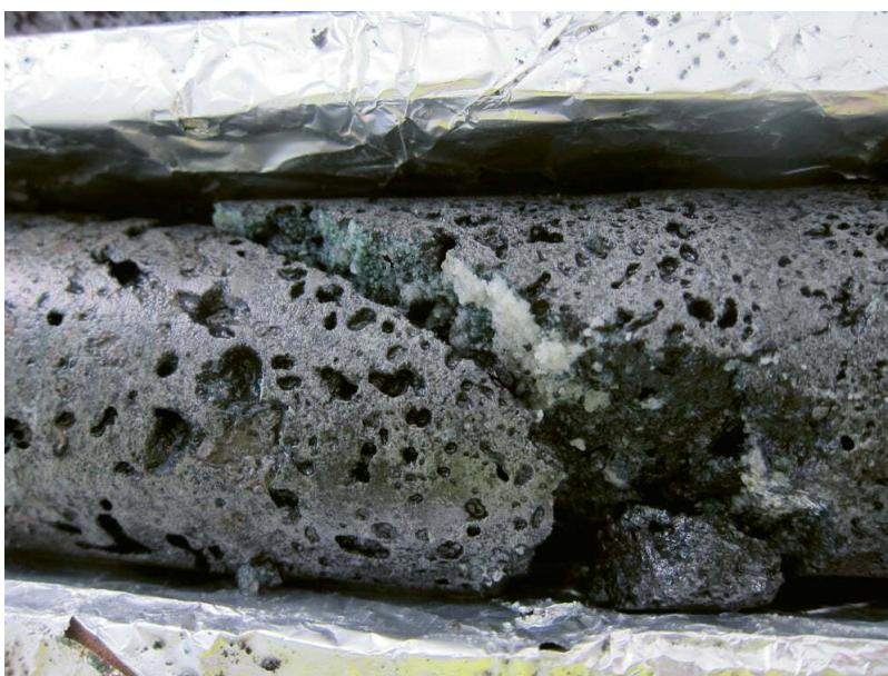
Aus Gas wird Stein: Mit dem Verfahren von Carbfix wandelt Climeworks CO<sub>2</sub> in Stein um. Bereits nach zwei Jahren sind 95 Prozent mineralisiert und können somit nicht mehr entweichen.
