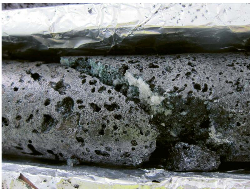
Aus Gas wird Stein: Mit dem Verfahren von Carbfix wandelt Climeworks CO<sub>2</sub> in Stein um. Bereits nach zwei Jahren sind 95 Prozent mineralisiert und können somit nicht mehr entweichen.
