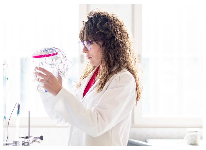
Vor der Verwendung im Beton werden die neuartigen pH-Sensoren von DuraMon zur Kalibrierung in alkalische Lösung getaucht. © ETH Foundation / Daniel Winkler 31. August 2023
