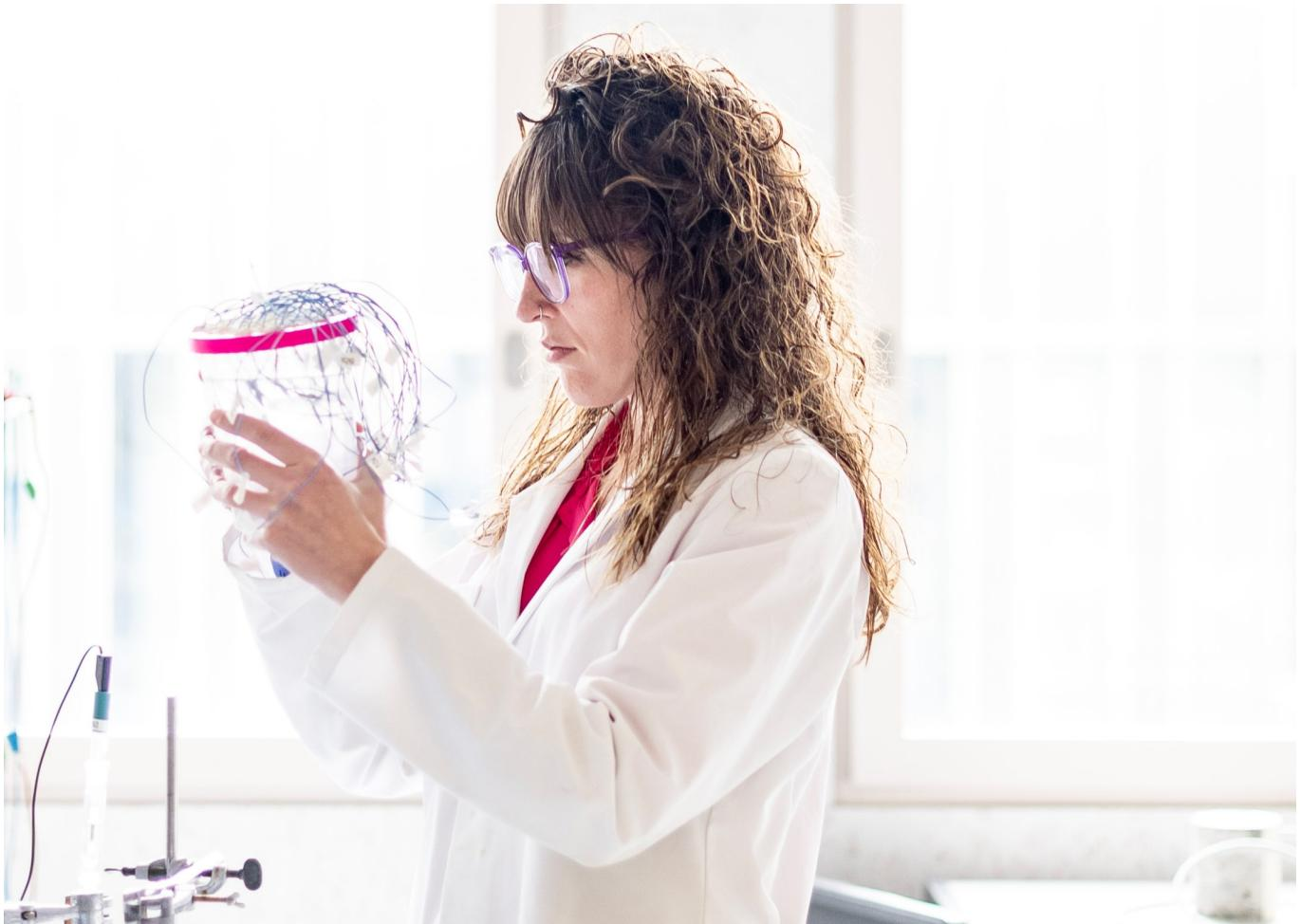
Vor der Verwendung im Beton werden die neuartigen pH-Sensoren von DuraMon zur Kalibrierung in alkalische Lösung getaucht.
